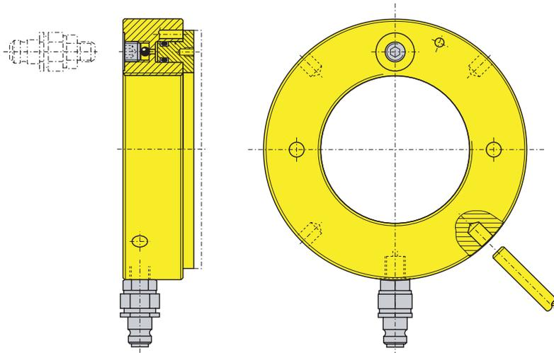
Die Hydraulikmutter 2-05510/2-05511 zeichnet sich aus durch die konsequente Auslegung für die Montage und Demontage von Wälzlagern, sowie für das Aufschieben von Naben auf konische Wellensitze. Das Hydraulikmedium ist Öl und kann über zwei Hydraulikanschlüsse G $\frac{1}{4}$  von einer Druckquelle (z.B. einer Handpumpe) zugeführt werden und zwar alternativ auf der Stirnseite oder auf der Mantelfläche.
