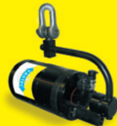
SPANNZYLINDER TYPE 6 M80 mit automatischem Kolbenrückzug, Überhubschutz (Ventil), Winkeldrehanschluss für Reihenschaltung, Spezialnuss zum Beidrehen der Hauptmutter und kugelgelagerter Anhängedrehvorrichtung für waagerechten und senkrechten Einsatz an schwer zugänglichen Stellen
