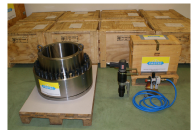
Spannmutter für Pressensäulen Ø450
